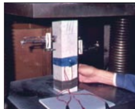
Katsekeha surveelastsusmooduli määramine pressi katsetel.
