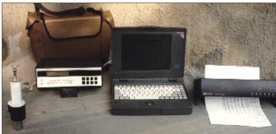
Betooni survetugevuse mõõtekomplekt CK BCM koos arvuti ja printeriga.
