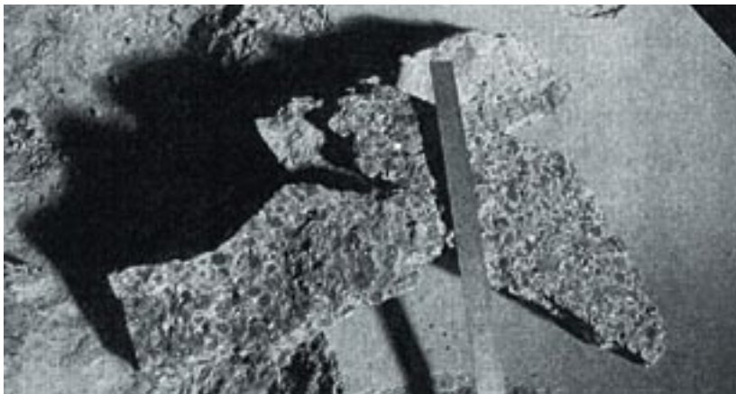
Joonis 4. Tulekatsel äkkvaringu tagajärjel tekkinud purustused
