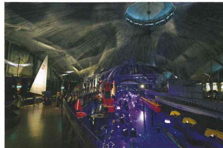
SELLEKS ET TAGADA konstruktsiooni tugevus, kaeti kuplid alt uue betoonkihiga.
